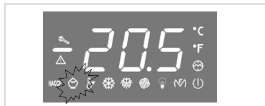
Ce LED indique l'activation de la fonction ENERGY SAVING (économie d'énergie)
