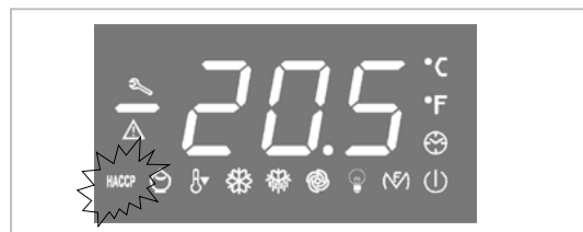
Ce LED indique un état d'alarme HACCP.
