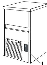
Für die permanent mit dem Stromnetz verbundenen Geräte gebe man Spannung, indem man auf den eigens in Installationsphase dafür vorgesehenen Schalter drückt, der sich außerhalb des Geräts befindet.
